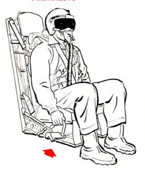
RAISING THE LEFT ARMREST LOCKS THE SHOULDER HARNESS. RAISING THE RIGHT ARMREST COCKS THE EJECTION TRIGGER AND BOTTOMS THE SEAT.
