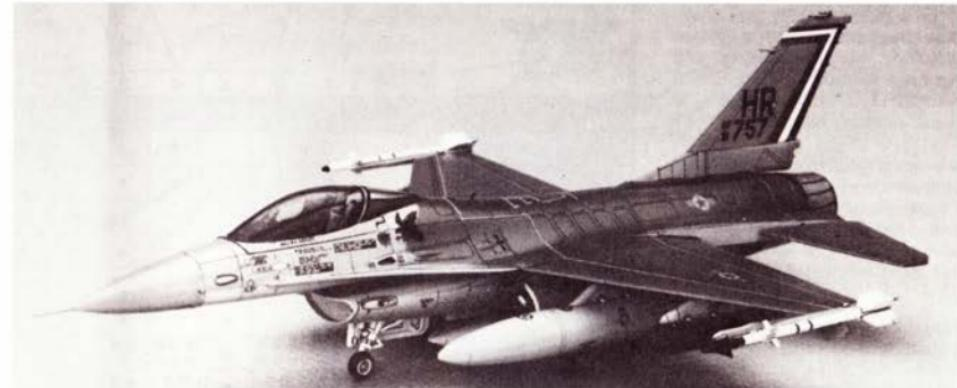
ジェネラル ダイナミックス F-16A PLUS ファイティング ファルコンは、F-16Aの発達型です。F-16A PLUSは対地攻撃能力の向上がなされ、搭載兵器の増大と多様化に対応する為、電子機器や機体構造の強化がなされています。又、爆撃時の安定性を増す為に水平尾翼は30%増強されています。最新型のF-16Cでは、武装搭載量をさらに増大し、電子機器も最新化されています。
