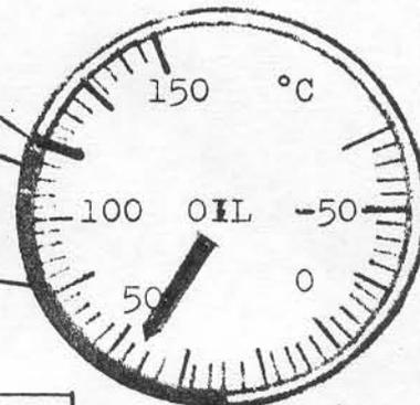
**ENGINE GEARBOX OIL TEMPERATURE**
